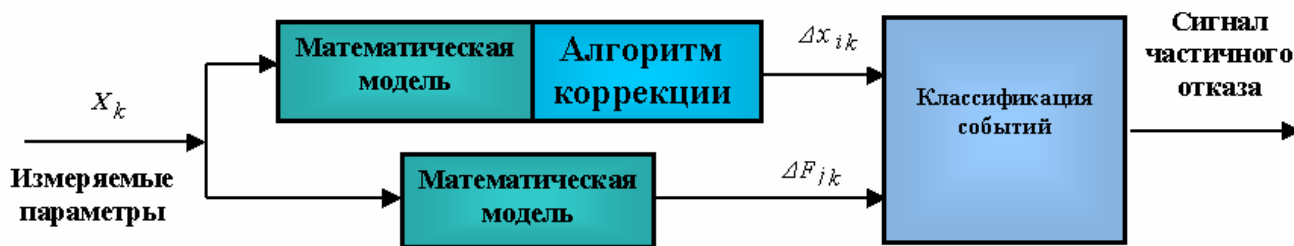
Рис.5. Структурная схема проведения диагностических процедур
